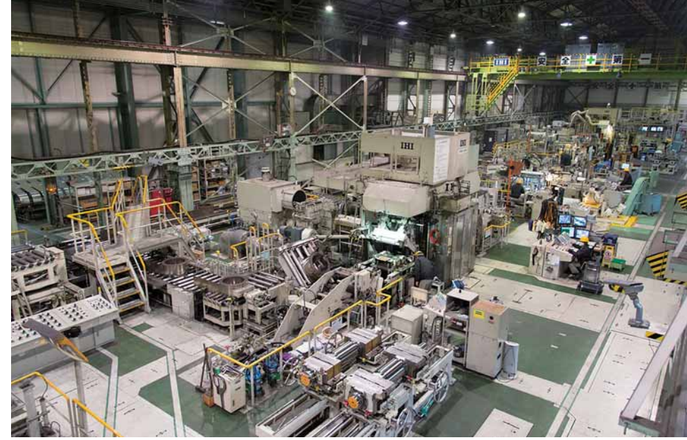
奥行きのある圧延工場内にはさまざまな機械がズラリ。機械を通るたび、少しずつ硬質になっていく様子が見える。
